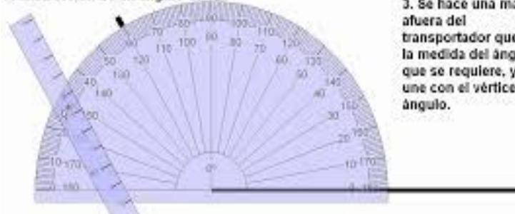
3. Se hace una marca afuera del transportador que sea la medida del ángulo que se requiere, y se une con el vértice del ángulo.
