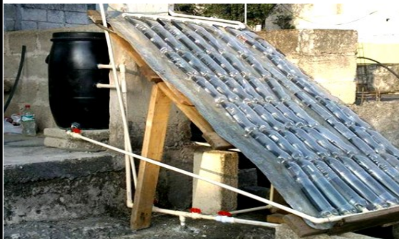
Calentador solar de agua casero con botellas de PET
