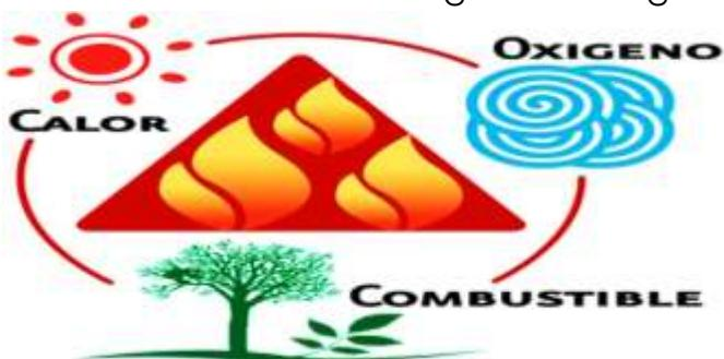
**El triángulo es de utilidad para explicar como podemos extinguir el fuego eliminando uno de los lados del triángulo.**
